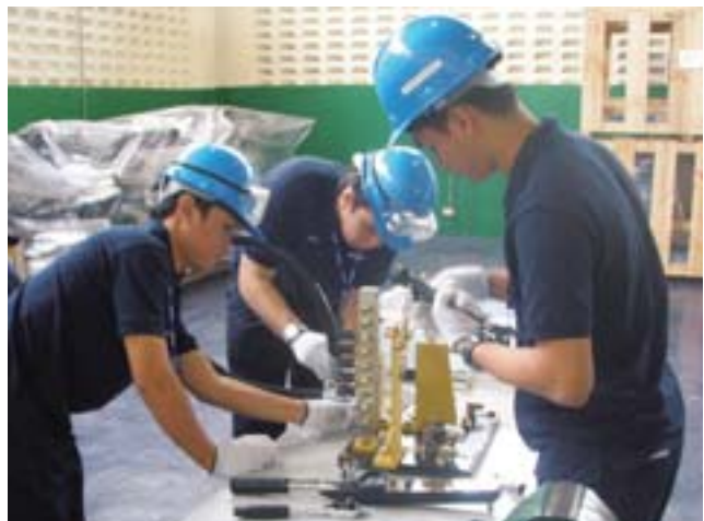
Cuando practican el apriete de mangueras de codo atornillable, los participantes en la capacitación aprietan primero el perno manualmente y confirman a continuación el apriete usando una llave de torsión.
