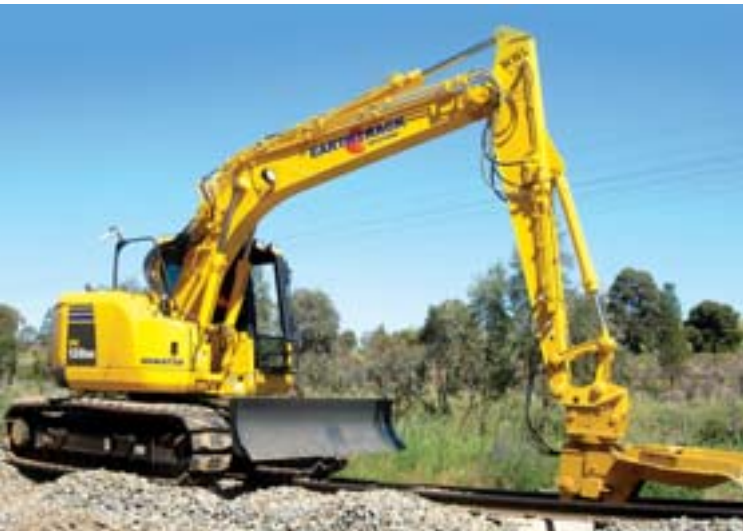
La PC138US modificada para rieles demuestra ser sumamente versátil.
