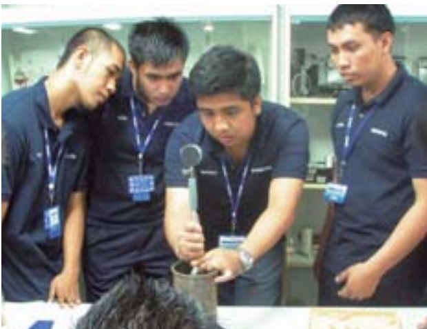
La capacitación en medición de alta precisión de diámetros interiores usando un calibrador para diámetros interiores
