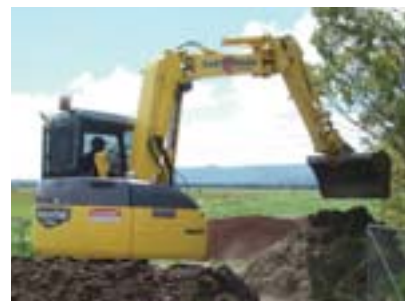
La excavadora PC78UU de radio de giro corto es adecuada para ser utilizada en espacios angostos.
