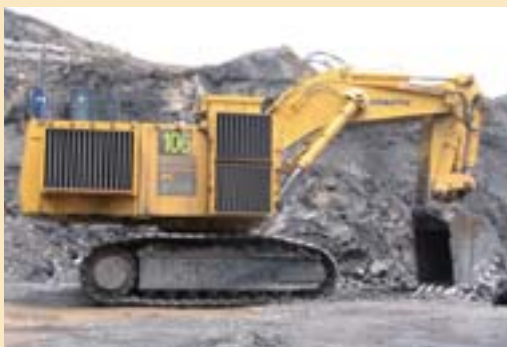
El sistema XS250 de Hensley se está utilizando en la excavadora hidráulica Komatsu PC3000.
